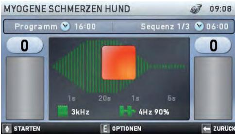
Um die Therapie zu starten, können Sie mit den linken ▲▼-Tasten die Intensität für Kanal 1 (auf der linken Seite) und mit den rechten ▲▼-Tasten die Intensität für Kanal 2 (auf der rechten Seite) einstellen. Mit den ▲-Tasten erhöhen Sie die Intensität des jeweiligen Kanals, mit den ▼-Tasten verringern Sie sie. Regeln Sie die Intensität auf einen für das Tier insgesamt angenehmen Wert.
