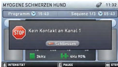
Überprüfen Sie in diesem Fall bitte, ob genügend Elektrodengeld auf den Elektroden des angegebenen Kanals und dem Fell aufgetragen ist, die Elektroden gut auf Fell oder Haut des Tieres befestigt sind und das Kabel fest in Gerät und Elektroden steckt. Überprüfen Sie in diesem Fall bitte, ob Sie die Elektrodenanlage gemäß der Beschreibung (siehe folgende Seiten) "Vorarbeiten zur Elektrodenplatzierung" durchgeführt haben. Die Elektroden müssen einen guten Hautkontakt haben.
